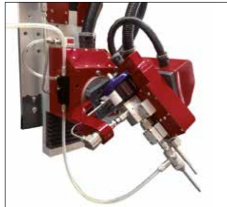
Система Edge с 5 интерполирующими осями \pm 55^\circ давлением до 4150 бар с системой ИТС (компенсация конусности) Edge 5 axis \pm 55^\circ interpolating system up to 4.150 Bar with I.T.C.(Intelligent Tapering Control)
